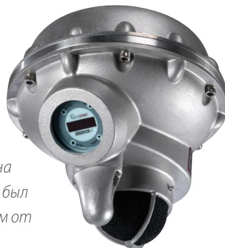
Благодаря технологии ANN GASSONIC OBSERVER-i может полноценно анализировать звуковой диапазон до 12 кГц, поскольку в нем не используются обычные высокочастотные фильтры. Использование таких передовых принципов увеличивает диапазон обнаружения утечек, а также повышает чувствительность в отношении небольших утечек за счет снижения влияния помех, вызываемых нежелательным фоновым шумом.
